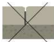
➤ nesprávne vytvorená šírka: – dištančná rozpera v škárovacej medzere so šírkou užšou ako 3 mm nezabrání nárazu jedného dlažbobného prvku do susedného.
